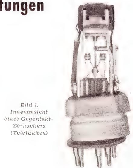
Bild 1. Innenansicht eines Gegentakt-Zerhackers (Telefunken)
