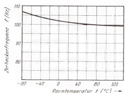
Bild 4. Abhängigkeit der Zerhackerfrequenz von der Raumtemperatur
