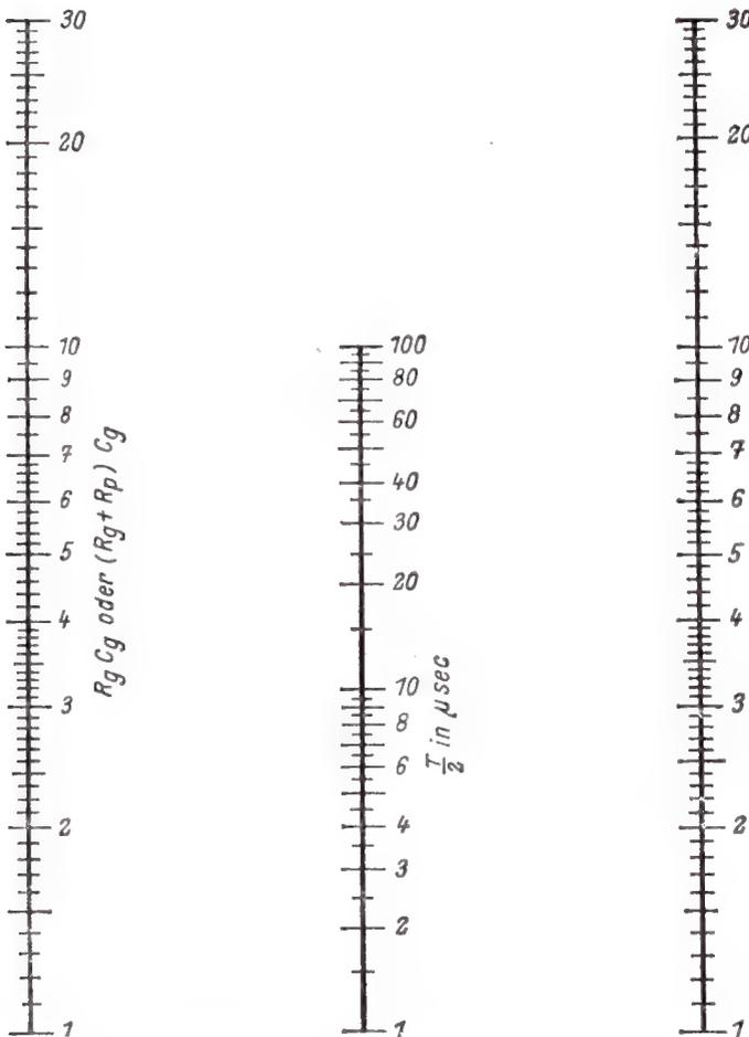
Bild 20. Nomogramm zur Errechnung der halben Periodendauer
