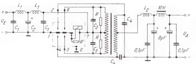
Bild 7. Schaltungsbeispiel für einen Wechselrichter; Gegentaktzerhacker mit Wiedergleichrichtung
