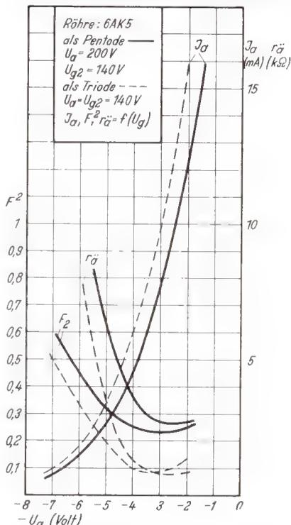
Bild 2. Experimentell gefundene Rauschkomponenten.  $F^2$  wurde durch Messung gemäß Bild 1,  $r_0$  auf rechnerischem Wege aus  $F^2$  ermittelt. Die zur Messung herangezogene Röhre weicht etwas von den normierten Daten der Röhre 6AK 5 ab. Die eingezeichneten Werte für  $F^2$  und  $r_0$  fallen auf Grund von Meßungenauigkeiten und nicht erfaßten Korrekturgrößen etwas größer aus als die sich aus den statischen Betriebsdaten ergebenden Größen
