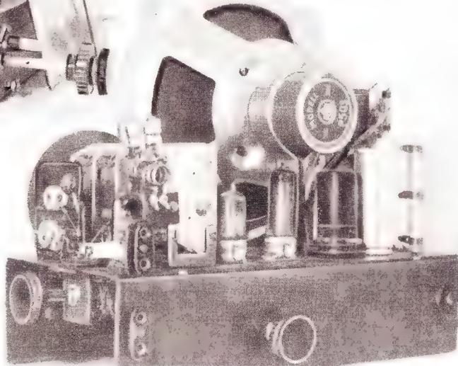
Die im Gitterkreis der Audionstufe angeordneten Schalterkontakte trennen in UKW-Stellung den Bandfilter-Sekundärkreis von der Gitterkombination. Zwischen Schirmgitter und Gitter der Demodulatorröhre UF 42 befindet sich jetzt der UKW-Schwingkreis. Die Ankopplung der Schwingkreisspule  $L_3$  geschieht durch die im Anodenkreis der Hf-Stufe angeordnete Wicklung  $L_7$ . Die Daten der UKW-Spulen gehen aus der umseitigen Tabelle hervor.
