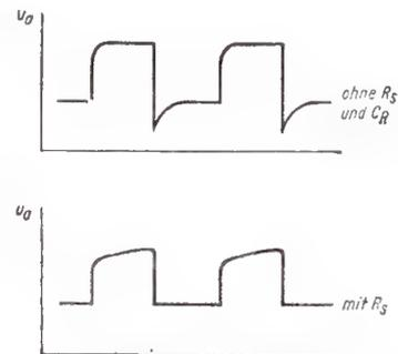
Bild 14. Impulsformen ohne und mit Gittervorwiderstand  $R_s$
