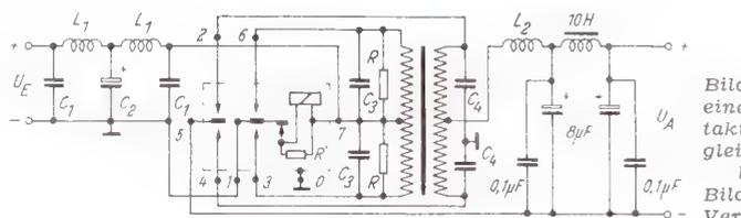
Bild 8. Schaltungsbeispiel für einen Wechselrichter; Gegentaktzerhacker mit Wiedergleichrichtung und mit isolierten Zungenhähften. Bilder 3 bis 10, 13 und 14: Nach Veröffentlichungen von NSF
