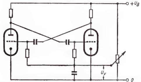
Bild 21. Multivibratorschaltung mit positiver Gittervorspannung  $U_V$
