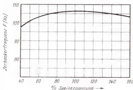
Bild 3. Abhängigkeit der Zerhackerfrequenz von der Speisespannung
