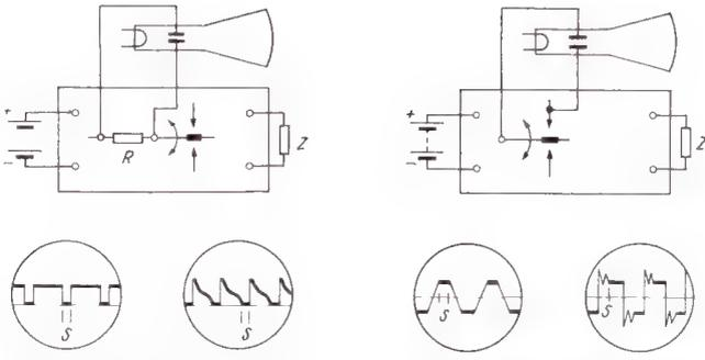
**Bild 9. Meßschaltung und Stromkurven eines Wechselrichters.** Links: Günstiger Schaltstromverlauf. Rechts: Ungünstiger Schaltstromverlauf, verursacht durch zu große kapazitive Last
