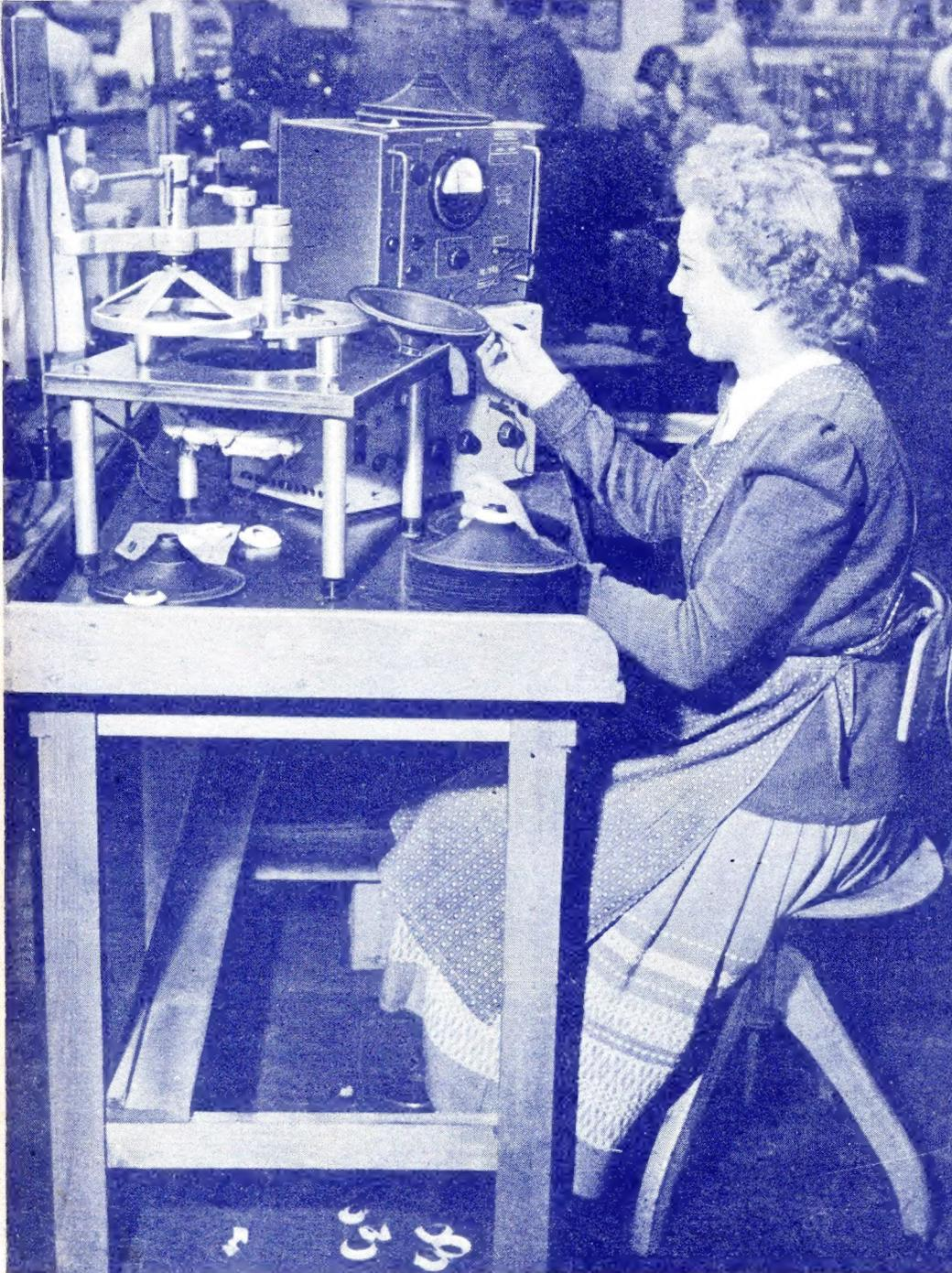
Lautsprecher-Membranen für Rundfunkempfänger werden am Prüfplatz vor dem Zusammenbau auf ihre Eigenfrequenz untersucht, damit auch in der Großserienfabrikation die klanglichen Eigenschaften genau eingehalten werden können. Ein aus einem Tongenerator gespeister Lautsprecher bläst die zu untersuchende Membran mit veränderlicher Frequenz an. Die Eigenresonanz des Prüflings ist an der größten Schwingweite erkenntlich; sie wird am Tongenerator abgelesen und auf der Membran verzeichnet.
