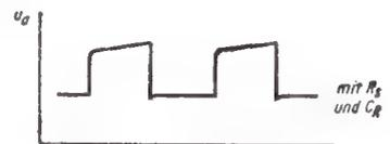
Bild 15. Impulsformverbesserung durch  $R_s$  und  $C_R$
