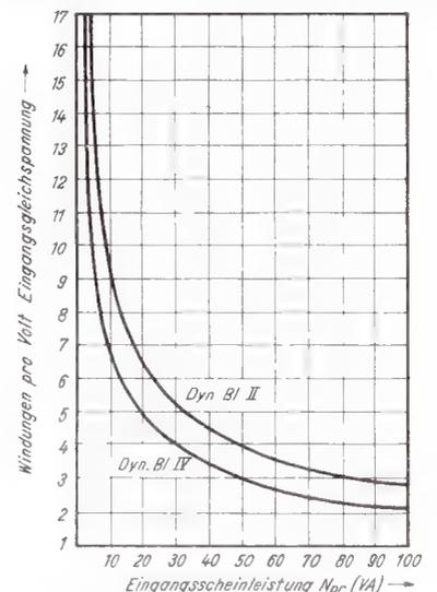
**Bild 14. Ermittlung der Windungszahl pro Volt Eingangsgleichspannung**
