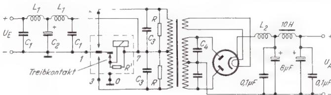
Bild 6. Schaltungsbeispiel für einen Wechselrichter; Gegentaktzerhacker ohne Wiedergleichrichtung
