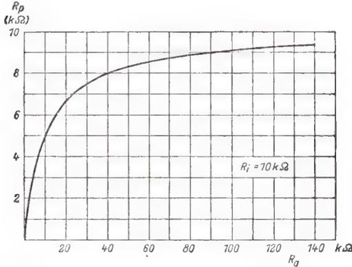
Bild 19.  $R_p$  in Abhängigkeit von  $R_a$  bei einem Wert von  $R_i = 10$  kΩ (ein meist gültiger Mittelwert für Trioden)
