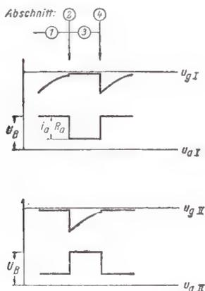
Bild 6. Grundsätzlicher Verlauf der Elektrodenspannungen an den Röhren
