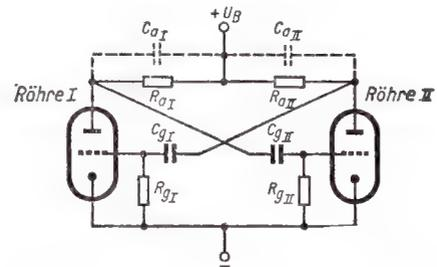
Bild 2. Symmetrische Darstellung der Schaltung Bild 1
